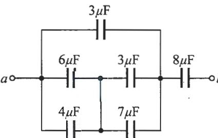
，電路  $ab$  間之等效電容為 \_\_\_\_\_  $\mu\text{F}$ 。
