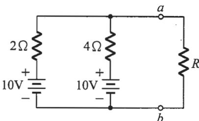
電路中， $R_L$  消耗的最大功率為 \_\_\_\_\_ W。
