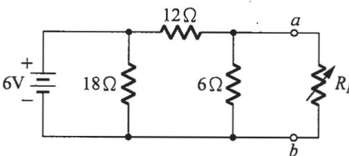
電路中，應調整  $R_L$  為 \_\_\_\_\_  $\Omega$  時，始可獲得最大功率輸出？
