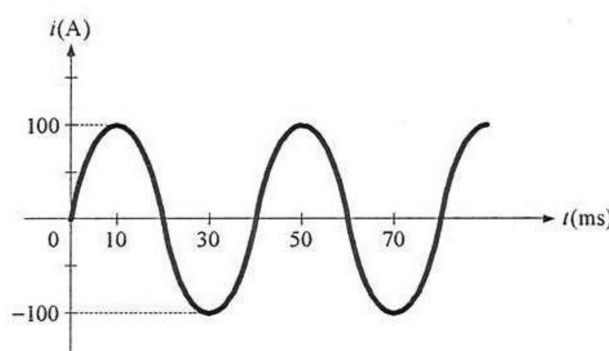
13. 求此電壓波形的平均值  $V_{av}$
