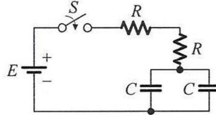
9. 如圖所示電路之電感及電容均無儲能，則在開關  $S$  閉合瞬間，電源電流  $I_S$  應為若干？
