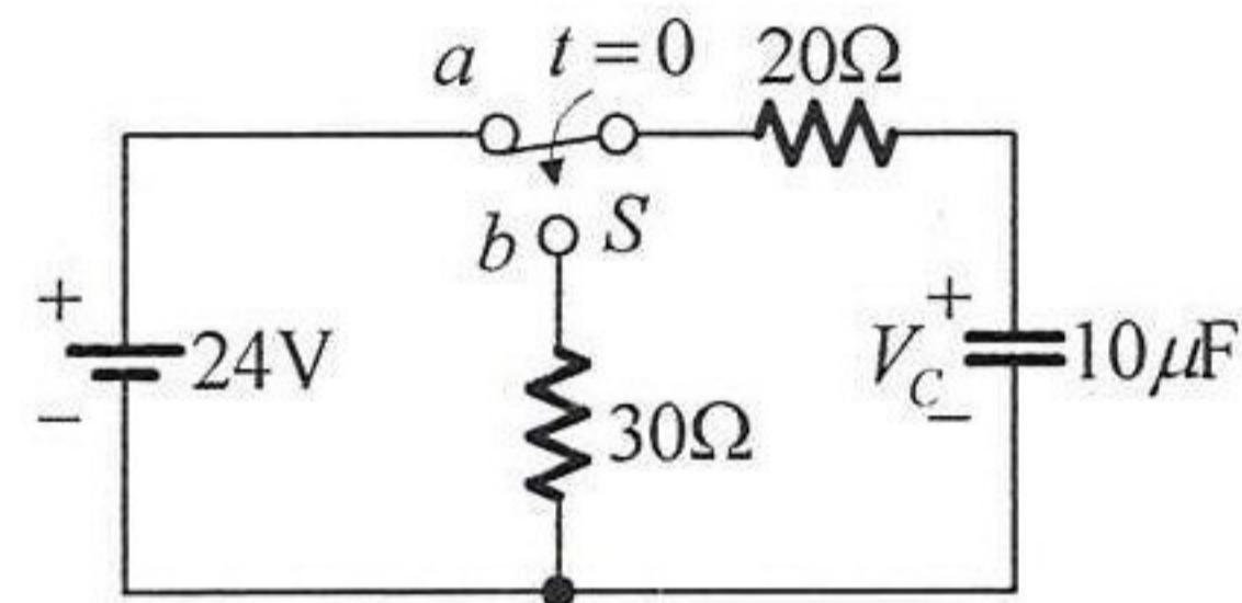
6. 如圖所示，若電路呈穩態後，從 1 切換至 2 的瞬間，則電阻上的電流為多少？
